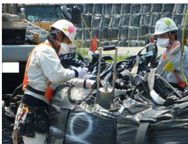
図 2.1.3-7 容器の表面線量率の測定状況
