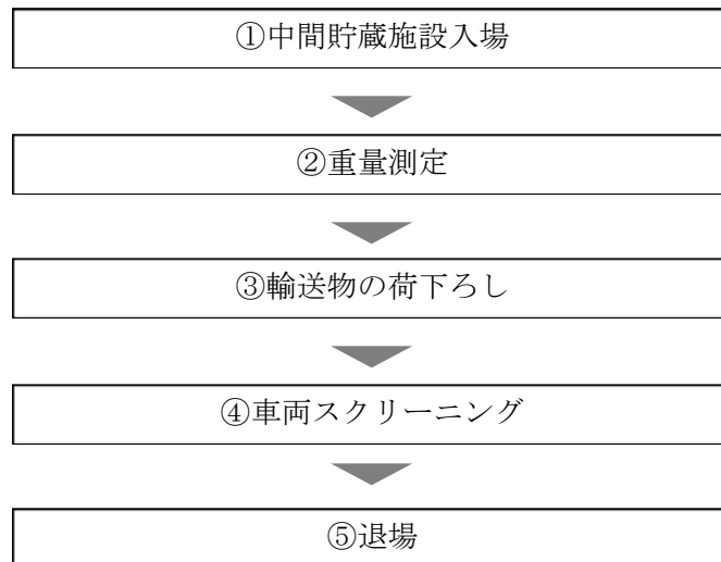
図 2.1.6-1 中間貯蔵施設における作業フロー
